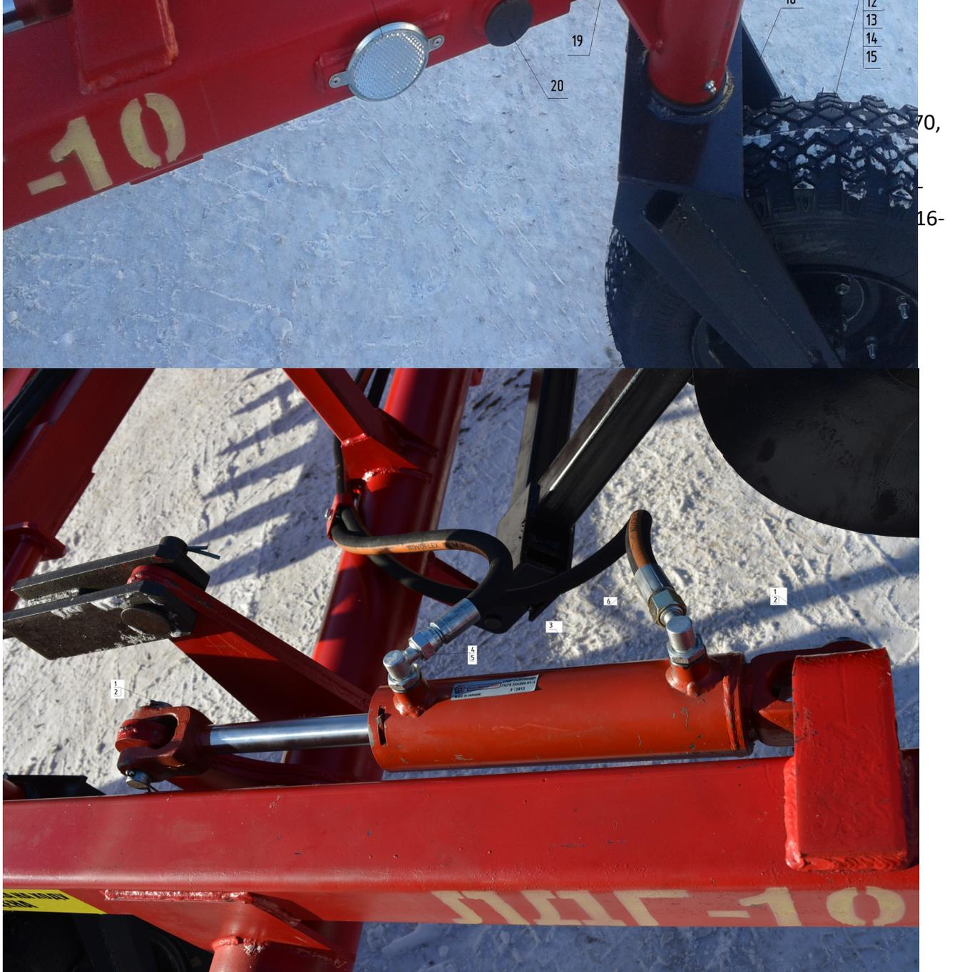
1-ось гидроцилиндра, 2-шплинт, 3-гидроцилиндр ГЦ 75.32x200.01-1, 4-угольник М20x1,5, 5-РВД 12-27,5 РОСТ 2SN (М20x1,5),L=7000 мм, 6-РВД 12-27,5 РОСТ 2SN (М20x1,5),L=7200 мм.
