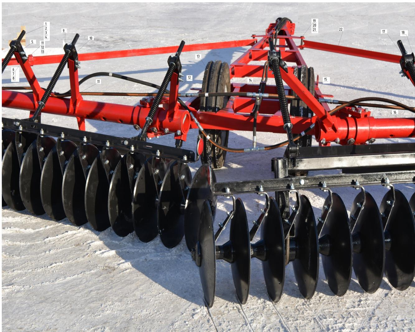
1-штанга ЛДГ-10.00.00.001, 2-шарнир ЛДГ-10.00.00.003, 3-шайба Ф20хФ40х4.019, 4-пружина ЛДГ-10.00.00.002, 5-щека ЛДГ-10.00.00.004, 6-болт М12х75.019 ГОСТ 7798-70, 7-гайка М12-7Н.019 ГОСТ 5915-70, 8-шайба 12.65Г.019 ГОСТ 6402-70, 9-щека ЛДГ-10.00.00.005, 10-щека ЛДГ-10.00.00.006, 11-брус левый ЛДГ-10.02.00.000, 12-тяга ЛДГ-10.05.00.000, 13-транспортные
